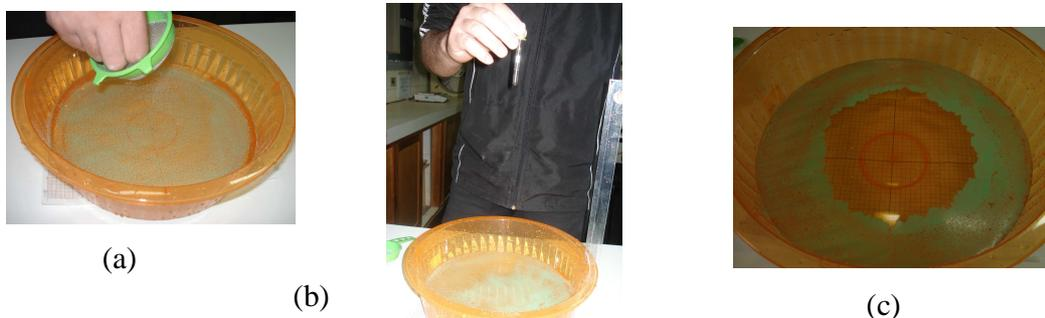
Figura 15.3 – (a) Foto da película formada por uma gota de solução alcoólica de ácido oléico. (b) Pingando a gota de solução; (c) Medir com a régua o diâmetro da película formada. Fotos tiradas pela autora.
