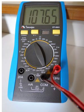
**Figura 14.3:** Multímetro ligado na escala de ohm, com os fios do PT 100 conectados.
