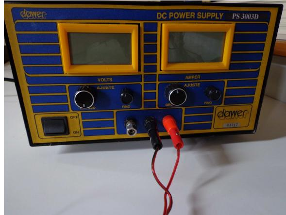
**Figura 14.4:** Foto da Fonte de tensão DC: botão liga e desliga; os dois botões à esquerda, são os que regulam a tensão (ajuste grosso e ajuste fino); e os dois à direita, são os liberam a corrente, e os pinos conectores da resistência interna da barra de metal.
