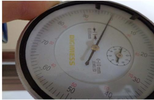
**Figura 14.2:** Foto do relógio comparador: para zerar gire a parte externa do relógio.
