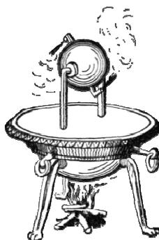
Figura 17.1 – Desenho esquemático da Eolípila a máquina de Heron. Figura extraída do site <http://pt.wikipedia.org/wiki/Eol%C3%ADpila>.
