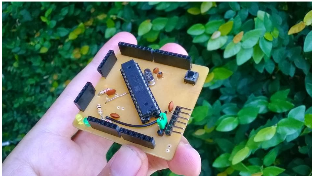
Figura 6 — Marminino, clone brasileiro do Arduino
