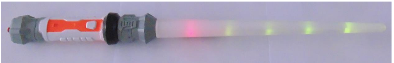
Figura A2 - Espada Jedi ligada, com um LED vermelho e quatro LEDs verdes acesos. Fonte: Autoria própria.
