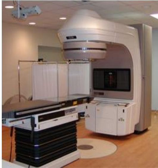
Figura 1.10 – Acelerador Varian Clinac 600 C/D [10].
