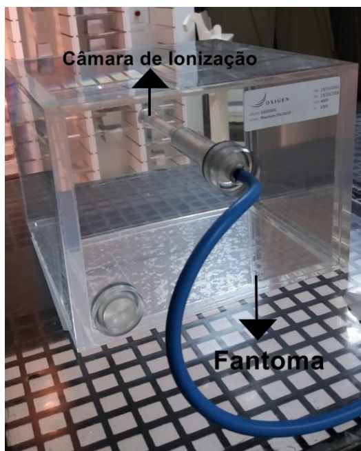
Figura 2.3 – Câmara de ionização e fantoma de água em equilíbrio.
