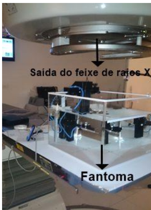
Figura 2.2 – Conjunto dosimétrico montado no acelerador linear.
