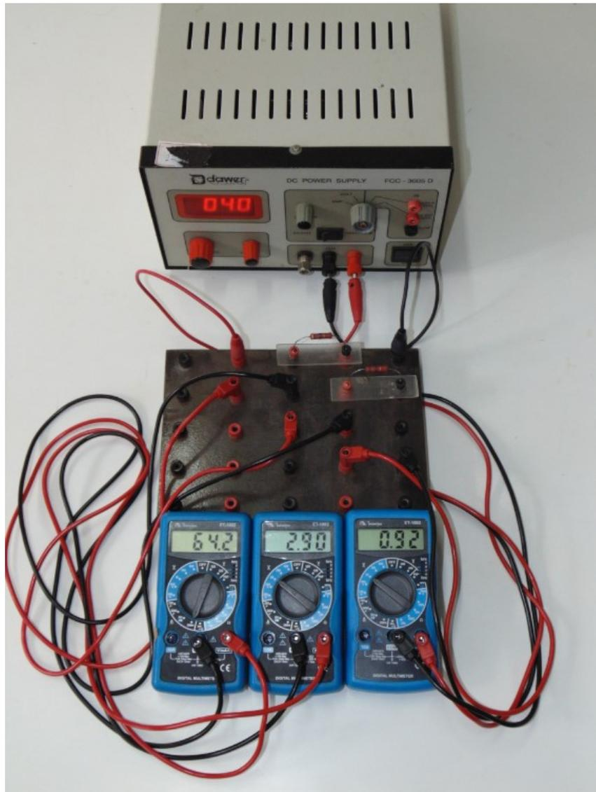
Figura 2.1 - Montagem básica para estudar a corrente e as tensões elétricas numa associação de dois resistores em série.
