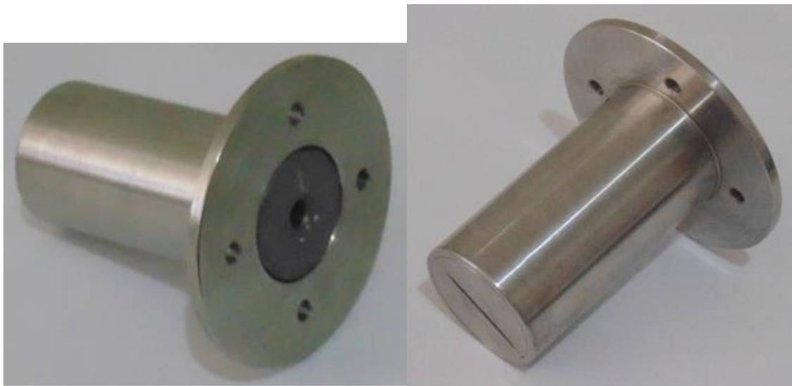
Figura 5.14 - Frente e verso do porta-fonte e colimador da fonte blindada montado.
