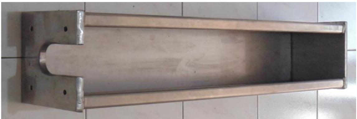
Figura 5.18 - Caixa de proteção para o feixe de radiação.
