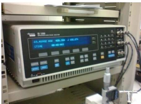
**Figura 11** – Analisador de impedância Solartron 1260A.
