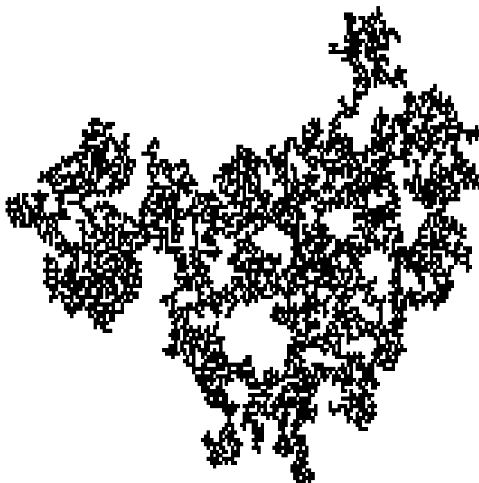
Figura 5.4: Representação gráfica do fluxo de um fluido em um meio poroso após 5000 sítios serem ocupados.
