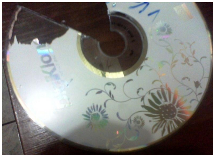
Imagem 10: CD com recorte já feito e com parte de seu adesivo superficial já removido. Fonte: Autoria própria.
