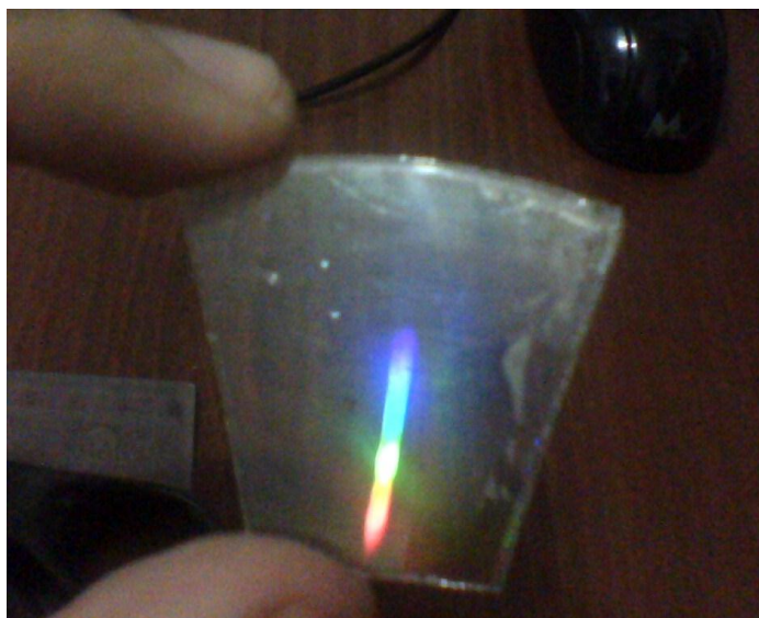
Imagem 11: Pedaco de CD (rede de difração) já pronto para uso. Fonte: Autoria própria.
