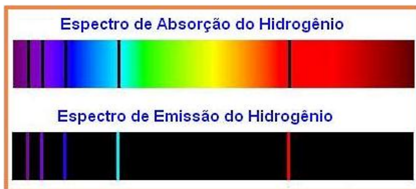
Figura 11: Espectro de absorção e emissão do Hidrogênio. Fonte: http://bussoladeplasma.files.wordpress.com/2013/01/espectro-de-emissc3a3o.png?w=472 .
