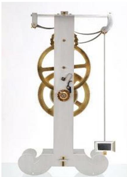
Figura 10: Réplica do Relógio pêndulo Huygens, construído com base na descoberta de Galileu.
