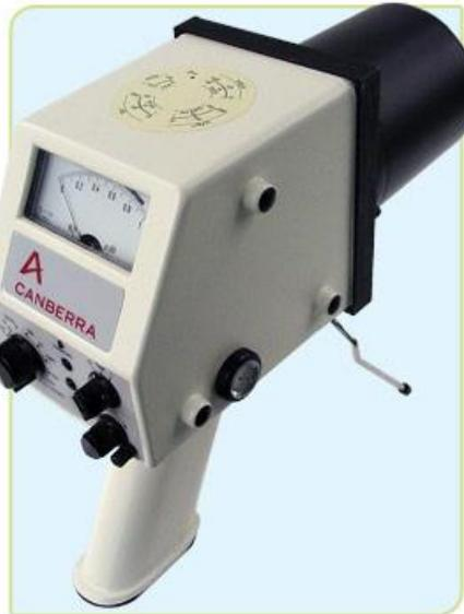
**Figura 5.0:** Câmara de ionização modelo Babyline81. ([www.canberra.com/fr](http://www.canberra.com/fr))
