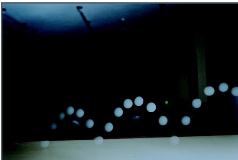
Figura 1.8 – Foto Estroboscópica da Trajetória de uma Bolinha de Ping-Pong
