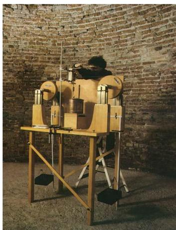
**Figura 10** – Réplica do dispositivo utilizado por Joule, em exposição em Oldenburg, na Alemanha
