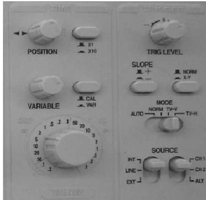
Figura 62: Funções das chaves Time e Trigger.
