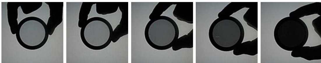
Figura 9 - Observação do efeito de um polarizador na luz de uma tela plana de computador
