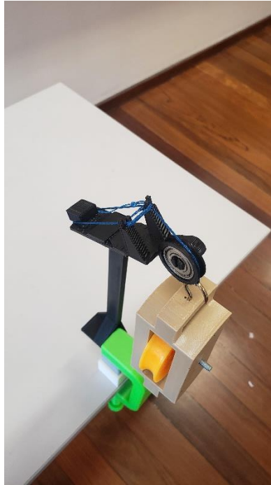
Figura 8: Máquina de Atwood – Polia fixa com gancho preso ao suporte.
