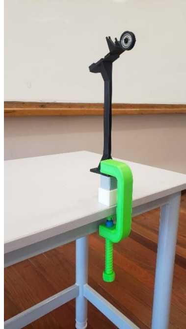
Figura 6: Máquina de Atwood – Suporte do aparato para a prática.
