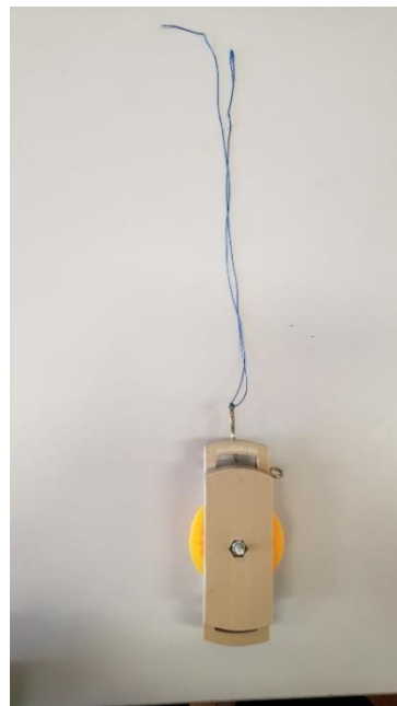
Figura 7: Máquina de Atwood – Barbante preso a polia fixa com gancho.
