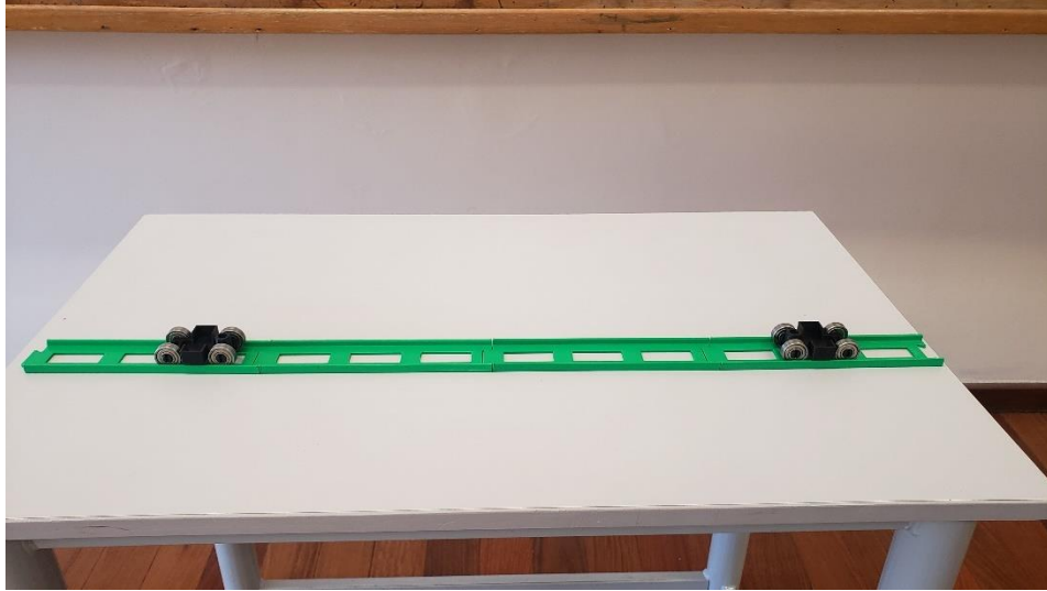
Figura 15: Colisões: Dois carrinhos, de impressão 3D com rodas de rolamentos, um em cada extremidade da pista unidimensional.
