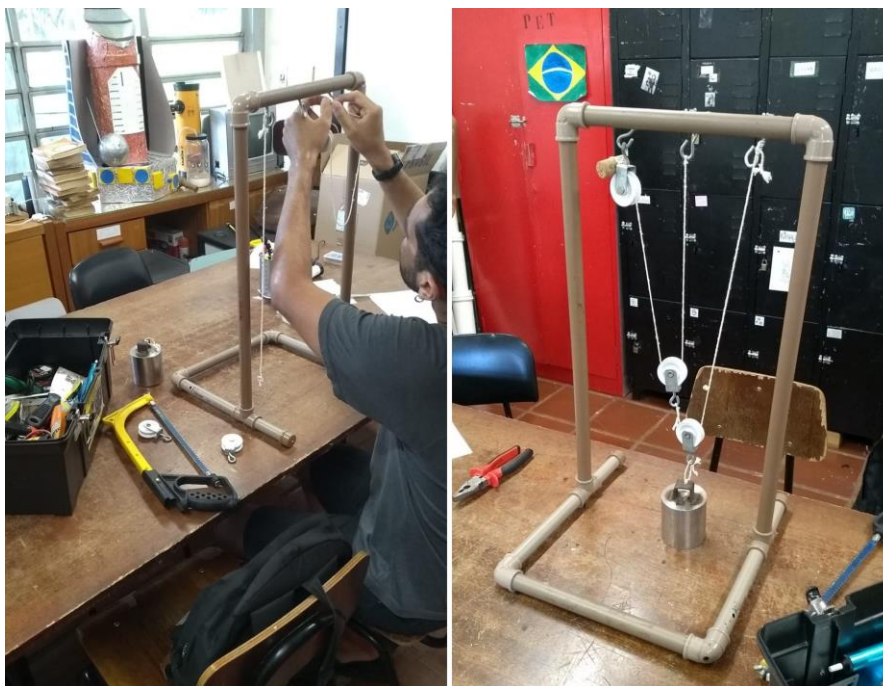
Figura 6: Integrante do PET Física realizando a montagem do experimento Multiplicador de Forças
