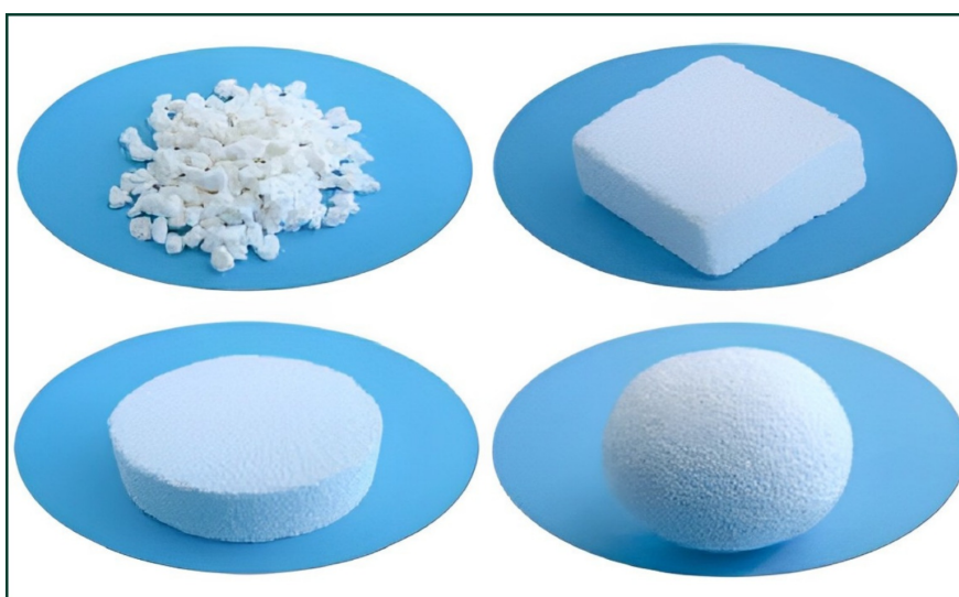
Figura 11: Diferentes formas de apresentação da Hidroxiapatita: granulados, blocos e esferas. [49]
