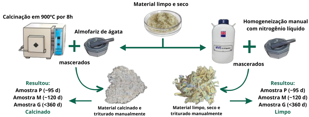
Figura 18: Procedimento experimental para obtenção de hidroxiapatita (HAp) e \beta -TCP em pó a partir de ossos de peixe. Também as etapas do processo para obter o osso apenas limpo para comparação. [Fonte: Autor]
