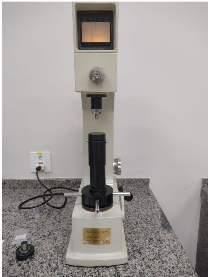
Figura 3.8 – Durômetro *Microtestet*; Série 0064; Modelo HBRV - pertencente ao laboratório de ensaios mecânicos do centro universitário Ingá [O autor, 2022].
