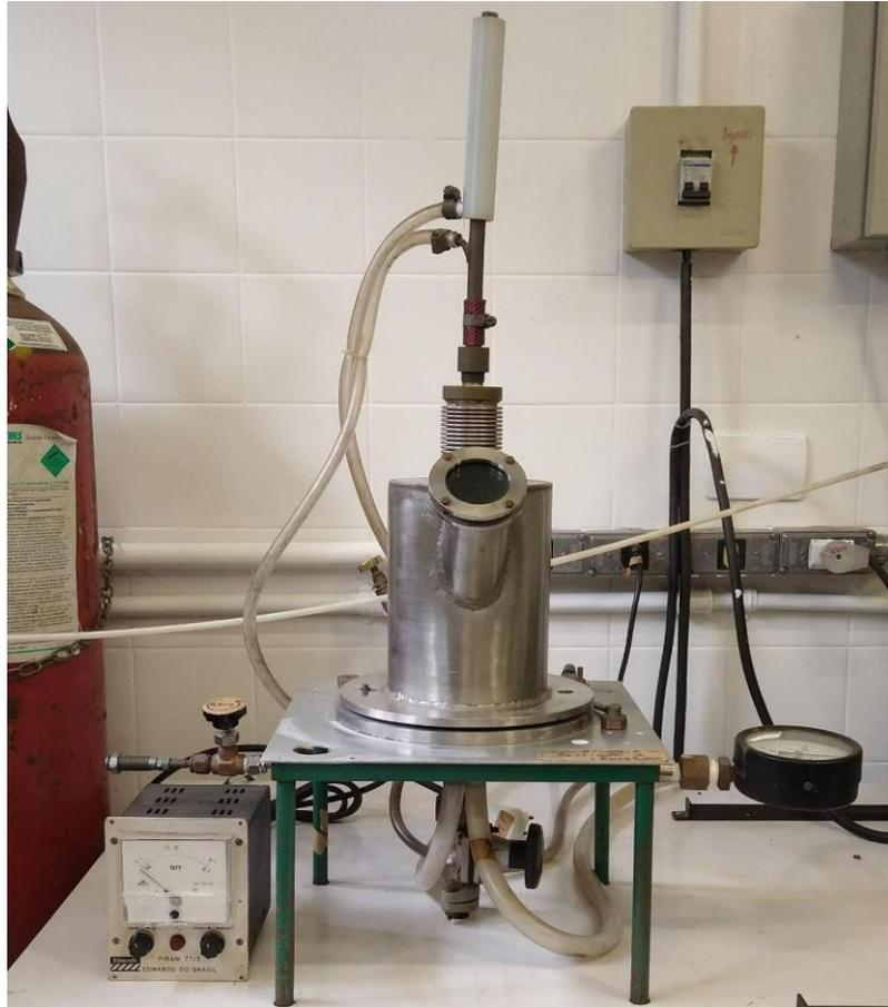
Figura 3.2 – Forno à arco voltaico com atmosfera de argônio pertence ao laboratório de Materiais especiais - Universidade Estadual de Maringá, utilizado nas fusões das amostras para produção da liga Ti-6Al-4V pura e da liga Ti-6Al-4V dopada com Fe e Gd [O autor, 2022].
