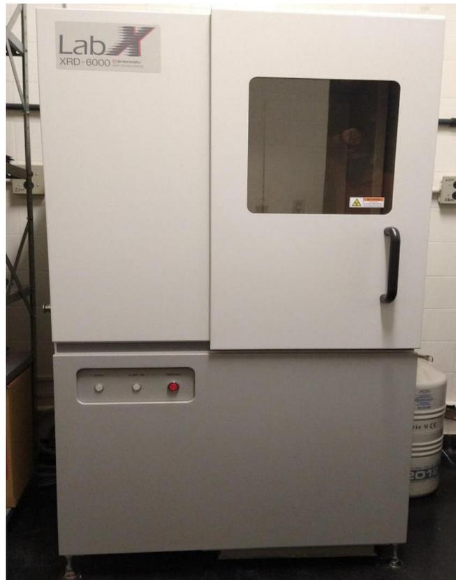
Figura 3.7 – Difratômetro de raios x - pertencente ao laboratório de Materiais especiais – UEM [O autor, 2022].
