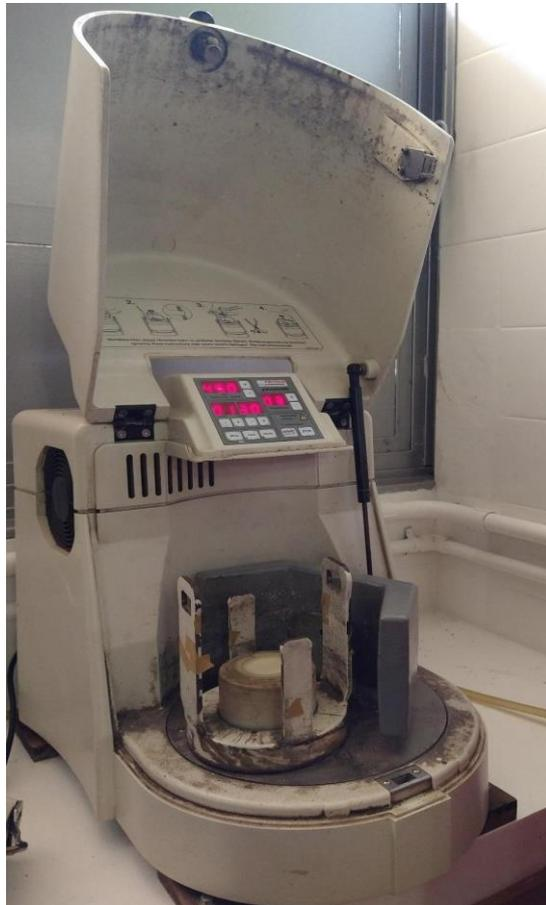
Figura 3.1 – Moinho mecânico de alta energia pertencente ao laboratório de Materiais especiais – Universidade Estadual de Maringá, utilizado no processo de moagem dos precursores para produção da liga Ti-6Al-4V [O autor, 2022].
