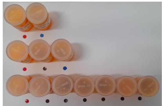
(b) Amostras já cortadas após retirada do molde. As de camada única com 0.11mm, as de dupla camada com 0.20mm e, por último, as de tripla camada com 0.28mm de espessura.
