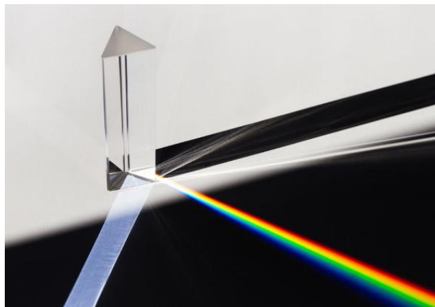
Figura 3: Fotografia de um feixe de luz branca atravessando um prisma e sofrendo o efeito de dispersão.
