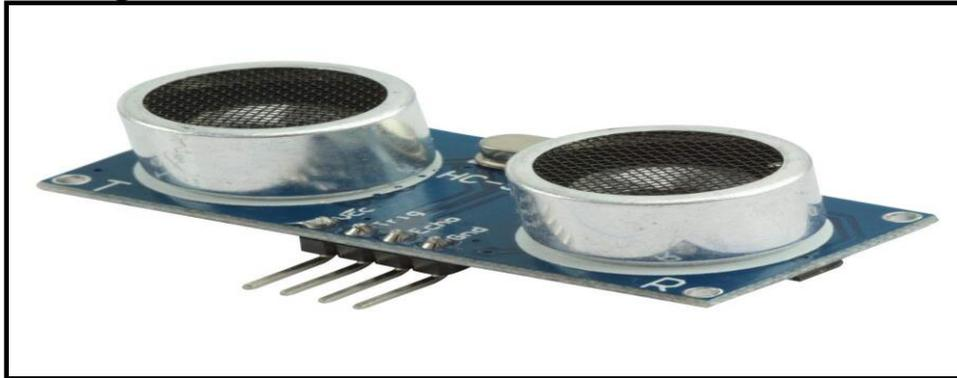
**Fonte:** Modulo Sensor de Distancia Ultrassônico, Chipsce, Hc-Sr04
