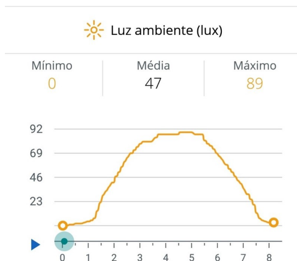
Figura 4.9 – Gráfico da intensidade da luz em função do tempo conforme variava o ângulo de incidência.
