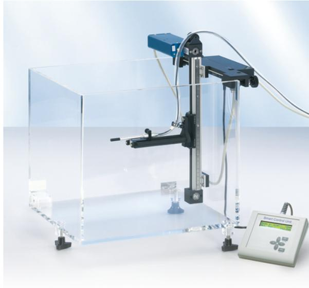
Figura 3.2: Exemplo de *Phantom* d'água.
