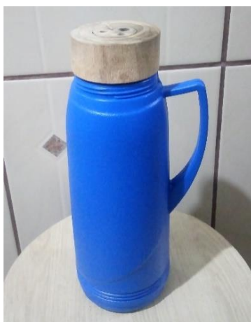
Figura 01- Recipiente fechado para ser utilizado como calorímetro.
