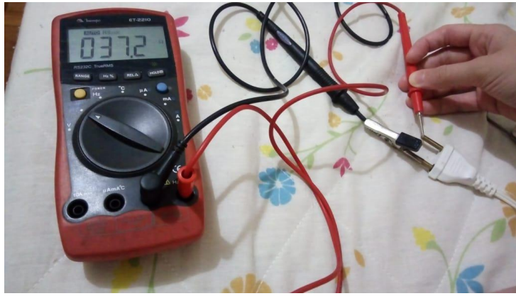
Figura 07- Medindo a resistência do “rabo quente”.
