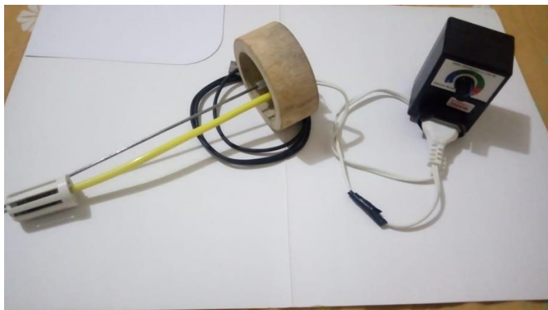
FIGURA 04- Montagem do aquecedor na tampa da garrafa térmica.
