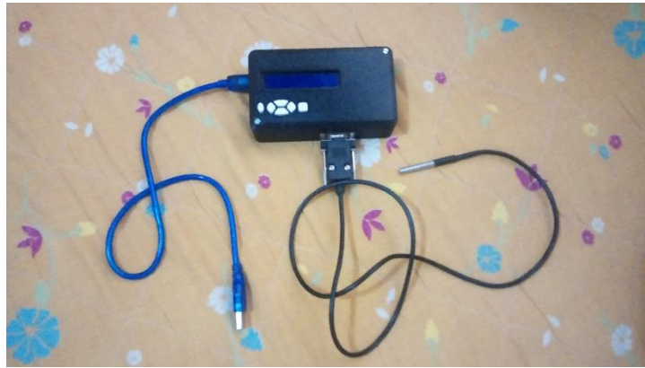
FIGURA 02- Termógrafo construído em outro projeto utilizando o sensor de temperatura DS18B20 (VISOVINI; FACHIM, 2014).
