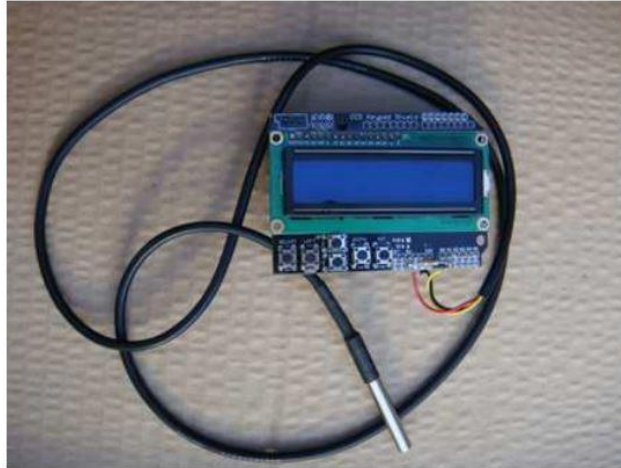
Figura 2: Composição do termógrafo sem a caixa plástica.
