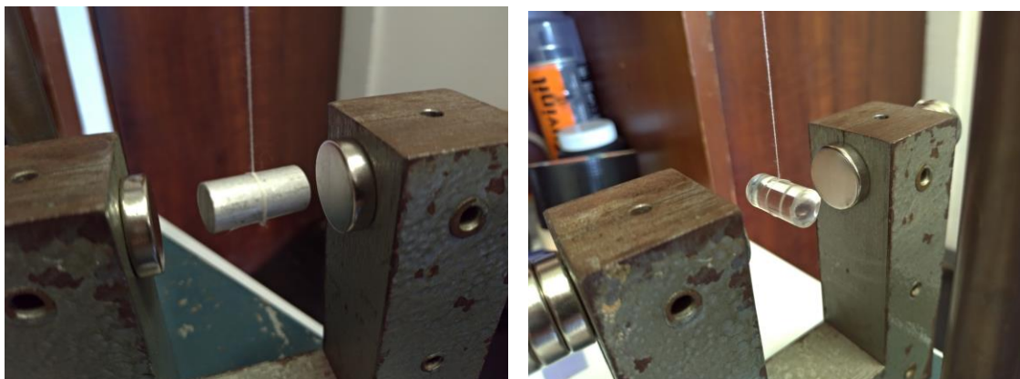
Figura 11 - Efeito do campo magnético sobre o alumínio (paramagnético) e o vidro (diamagnético)
