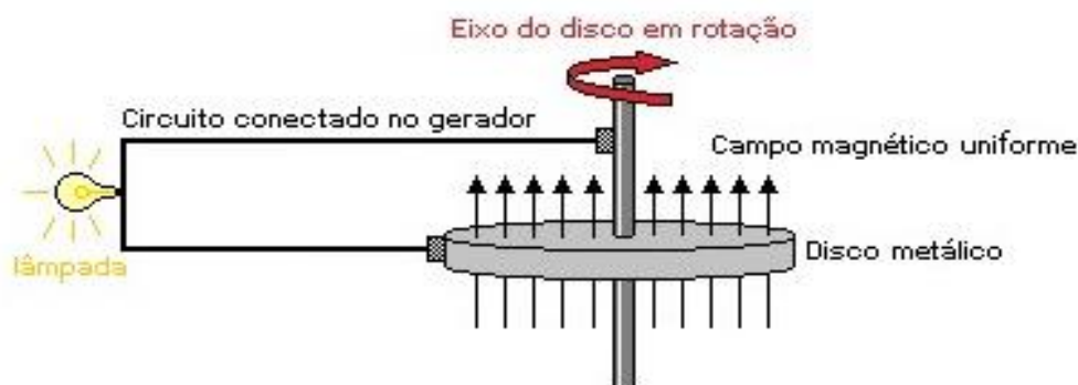
Figura 8 – Esquema ilustrativo de um gerador homopolar
