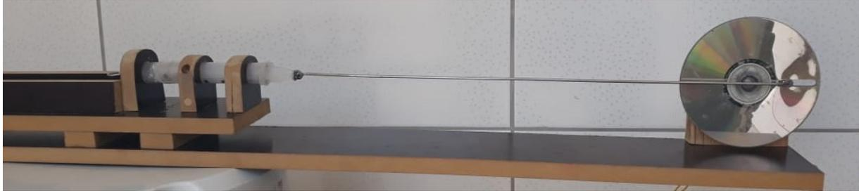
Figura 11: Modelo de um oscilador amortecido e forçado
