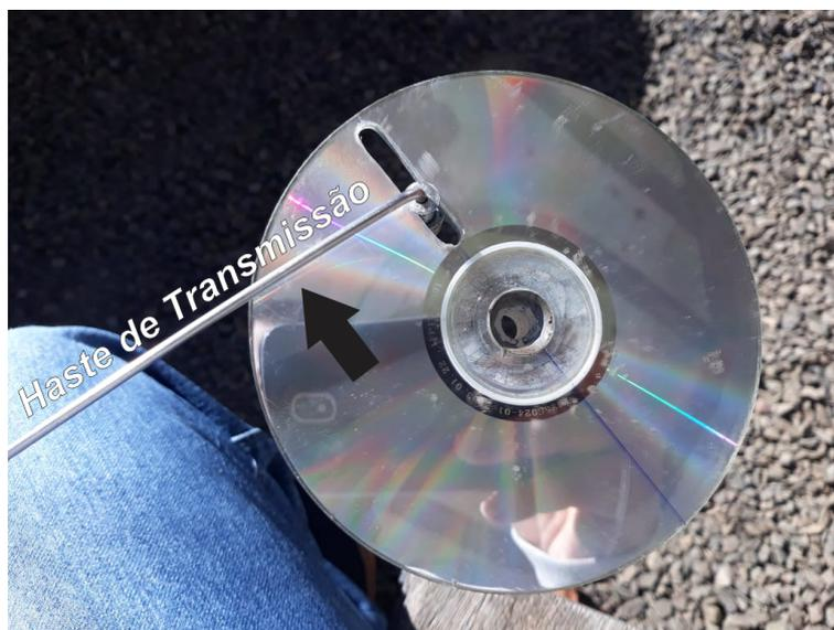
Figura 20: Esquema do CD Triplo com a Haste de transmissão
