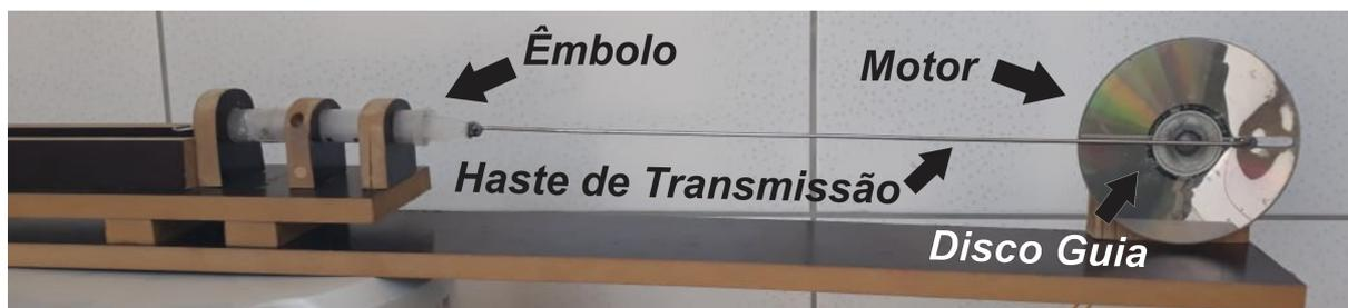
Figura 21: Parte do Oscilador da maquete
