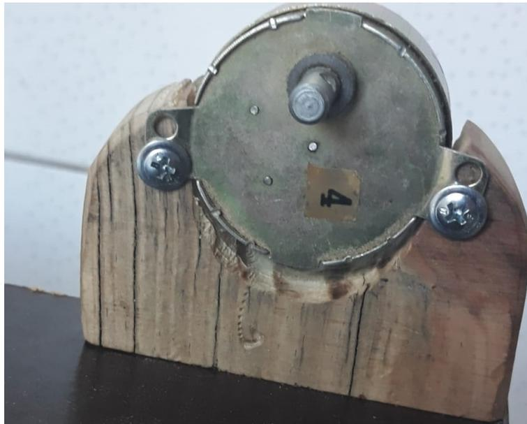
Figura 17: Esquema de Fixação do Motor
