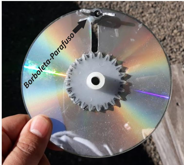
Figura 19: Esquema do CD Triplo com a engrenagem do motor
