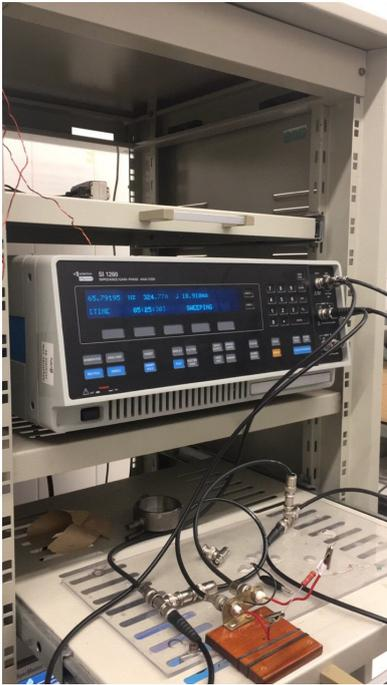
Figura 2.1: Solartron 1260A utilizado para fazer as medições ligado a um computador e ao suporte utilizado para prender os circuitos. O software utilizado para recolher os dados experimentais no computador foi o SweepRepeat.
