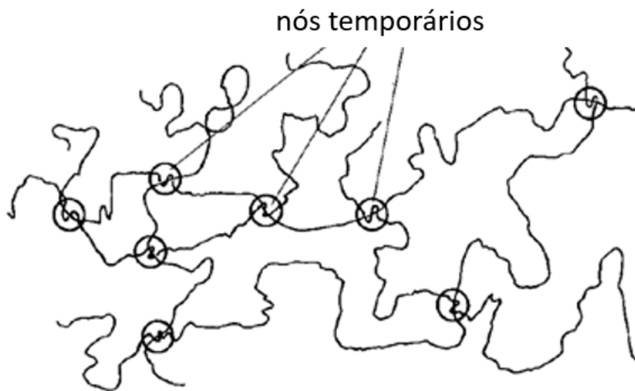
Figura 3.13: Cadeias poliméricas ligadas através de "nós" temporários. Imagem adaptada da referência [22].
