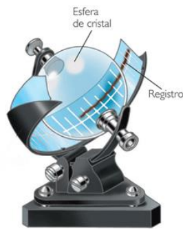
Figura 18 – Esquema do heliógrafo Campbell-Stokes.
