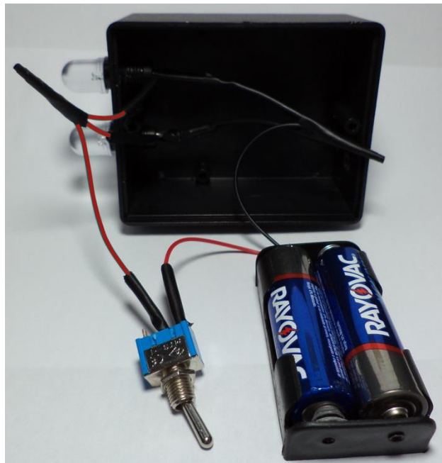
Figura 9: LEDs e chave alavanca conectados aos fios do suporte para pilhas e encapados com fita isolante.
