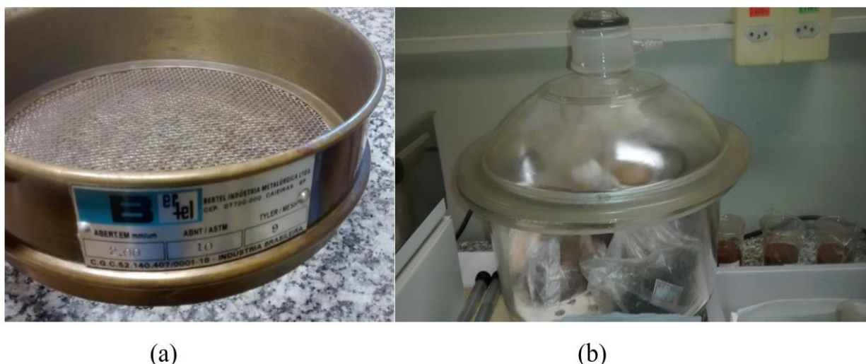
Figura 3.4: Imagem fotográfica do material utilizado para o preparo da TFSA: a) Peneira para a tamisação e b) Dessecador para evitar umidade nas amostras de TFSA.
