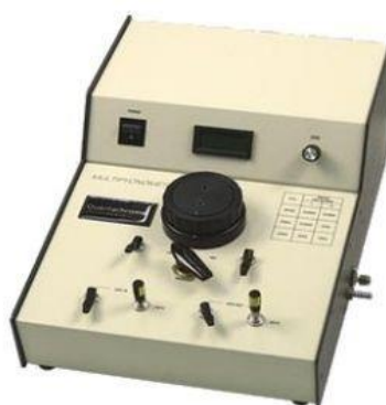
Figura 3.5: Imagem fotográfica do Picnômetro (MVP-D160) utilizado para determinação da densidade das amostras de TFSA [55].
