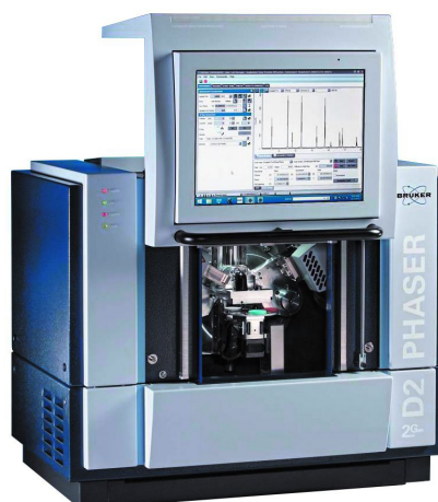
Figura 3.3: Difratorômetro de raios-X similar ao utilizado para as medidas [58].
