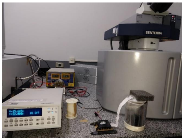
Figura 3.3 – Sistema de aquecimento em conjunto com o Microscópio Raman.
