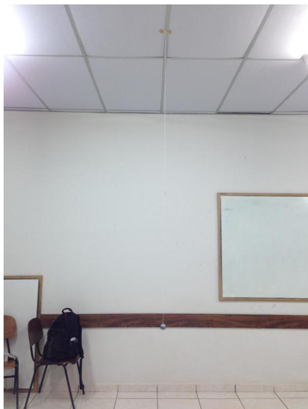
**Figura 10** – Foto do pêndulo simples com dois metros de comprimento
