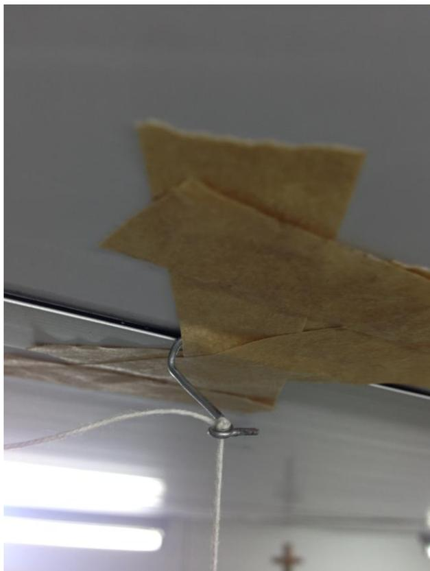
**Figura 9** – Suporte do pêndulo simples
