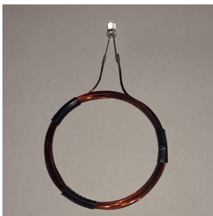
Figura 19 - Imagem fotográfica bobina receptora.
