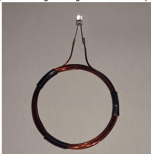
Figura 9 - Imagem fotográfica bobina receptora.
